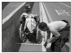
(a) Ramp gradient measurement<sup>5</sup>
